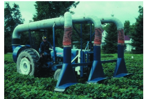
Le Biovac, méthode de lutte pneumatique contre la punaise terne (photo : C. Vincent)
